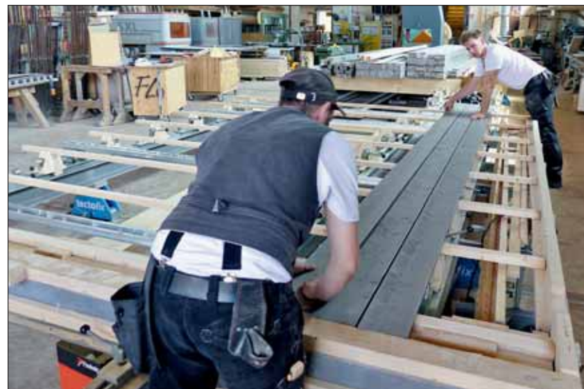
Mit dem Fassaden-Tool können nun auf dem „Tectofix“-Arbeitstisch auch offene Holzfassaden mit den selben Vorteilen der vollflächigen Verfertigung hergestellt werden, wie dies bislang für Dachstühle und Rahmenbauwände der Fall war.
