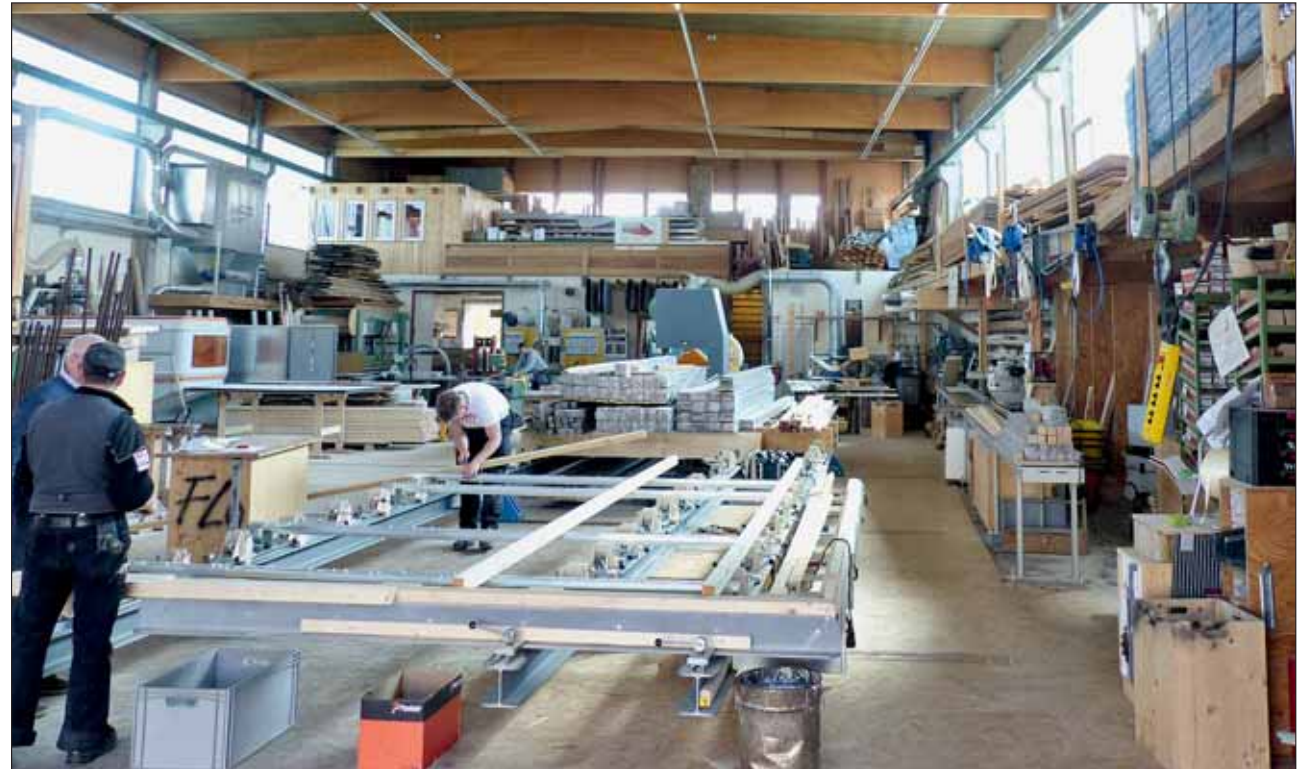
Blick in die Abbundhalle der Firma Muny, im Vordergrund der „Tectofix“-Arbeitstisch, im Hintergrund links das CNC-Bearbeitungszentrum. Fotos: J. Härer
