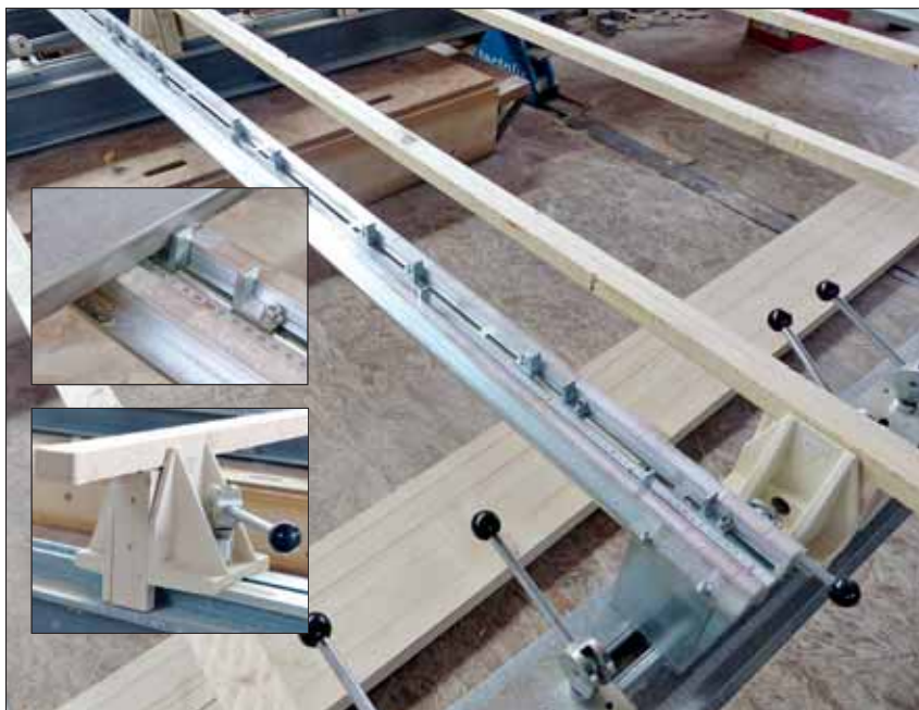
Mit dem Fassaden-Tool können nun auf dem „Tectofix“-Arbeitstisch auch offene Holzfassaden mit den selben Vorteilen der vollflächigen Verfertigung hergestellt werden, wie dies bislang für Dachstühle und Rahmenbauwände der Fall war.
